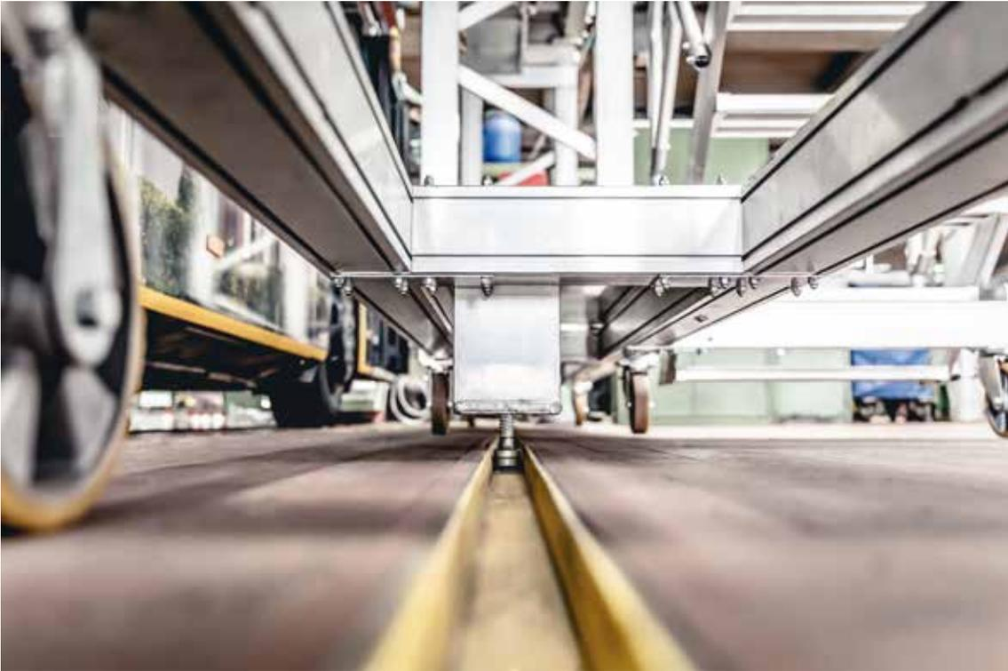
Eine fixierte Schienenführung sorgt für Sicherheit beim Verfahren der Dacharbeitsbühne und verhindert Beschädigungen an den Bussen
