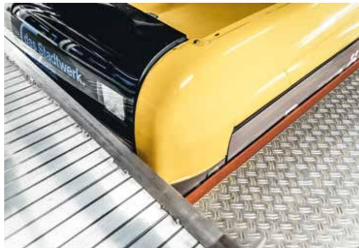
Die seitlichen Arbeitsplattformen verfügen über einen Aluminium-Plattformbelag mit einer Rutschhemmung der Bewertungsgruppe R9 und können mit Spaltmaß Null an den Bussen andocken
