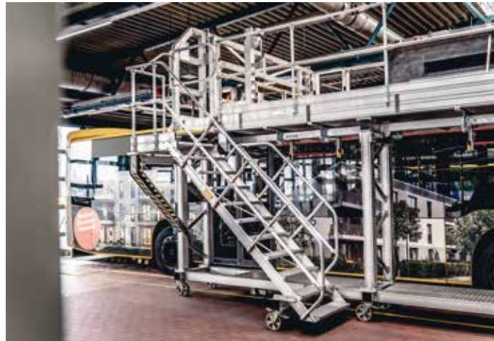
Der Aufstieg auf die Dacharbeitsbühne erfolgt seitlich über eine Treppe mit Handlauf und Geländer sowie selbstschließender Sicherungstür
