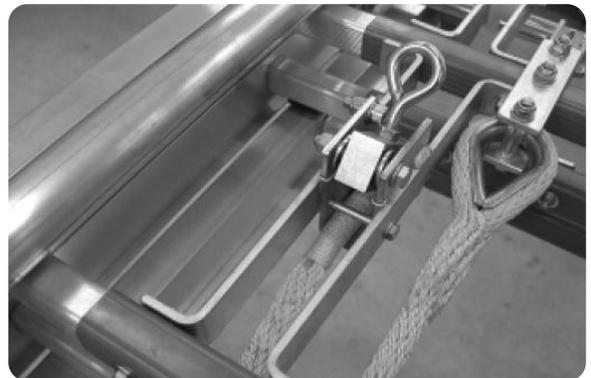
Führen Sie das Auszugsseil unbedingt durch die Ringschraube, da sonst die Bremse nicht gelöst werden kann.
