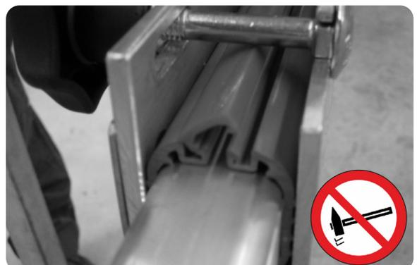
Lösen Sie nun die Schrauben des Montagewerkzeuges und nehmen es ab. Prüfen Sie den Sprossenschutz auf festen Sitz.
