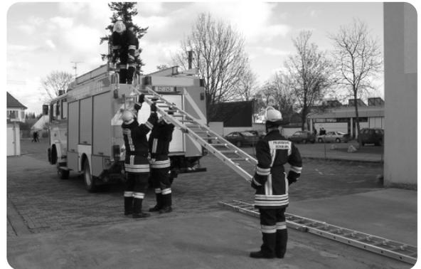
Muss die Steckleiter auf engem Raum aufgestellt werden, kann dieses durch Untersetzen geschehen. Zwei Personen heben das Leiterteil an den Federbolzen und den Holmen hoch und legen dieses möglichst schräg an das Objekt an.
