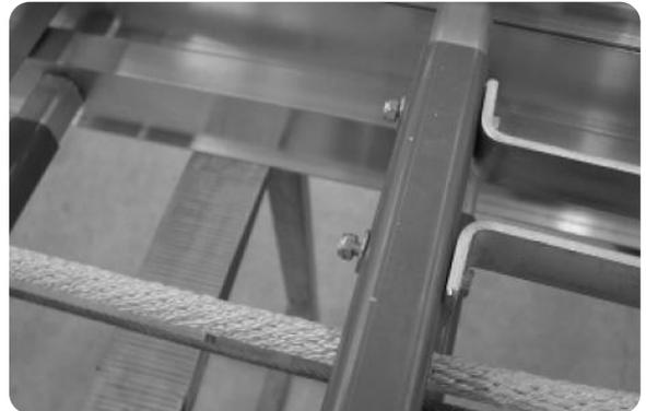
Ziehen Sie den Bremshebel nach oben und schieben das Auszugsseil unter dem Bremsschuh durch. Anschließend Seil über die Umlenkrolle weiterführen.
