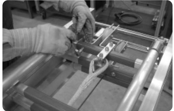
Ersetzen Sie diese durch die mitgelieferten längeren Schrauben M6 x 50 und Sicherungsmuttern M6.
