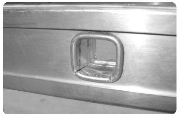
Drücken Sie das Sprossenende mit einer Wasserpumpenzange zusammen.
