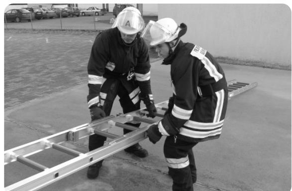
Achten Sie darauf, dass die Federbolzen in die zusammengesteckten Leiterteile eingerastet sind. Benötigen Sie nur drei Leiterteile, wird jetzt das vierte Leiterteil durch Lösen der Federbolzen abgenommen.
