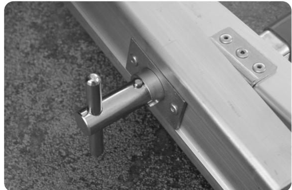
Um die Leiterteile zusammen zu stecken halten zwei Personen die unteren Leiterteile an der oberen Sprosse mit der einen Hand hoch, mit der anderen Hand betätigen sie den Federbolzen der oberen Leiter. Die anderen Personen schieben jetzt die Leiterteile zusammen.
