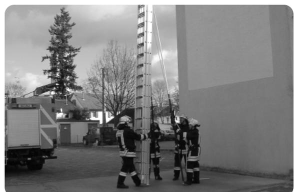
Die beiden Personen an den Stützstangen sichern die Leiter. Eine Person tritt vor die Leiter und achtet auf sicheren Stand des Leiterfußes. Hierzu wird der Fuß auf die untere Querstange gesetzt und die Leiter außen an den Holmen gefasst. Die Person überwacht gleichzeitig das Ausziehen der Leiter.
