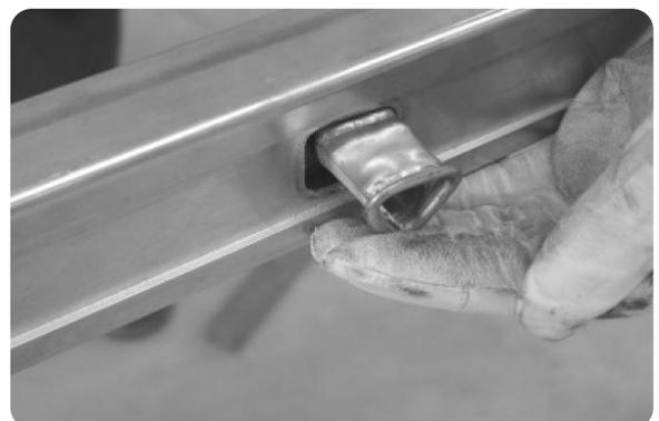
Schneiden Sie nun die Ersatzsprosse zu. Bei einer Oberleiter benötigen Sie eine Sprossenlänge von 403 mm, bei einer Mittel- bzw. Unterleiter eine Länge von 494 mm.
