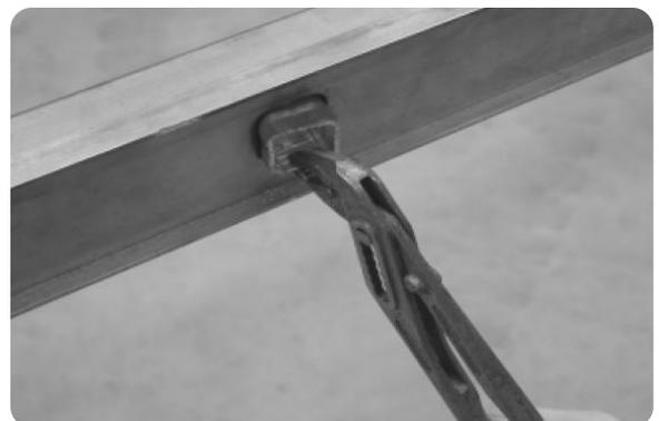
Entfernen Sie das zusammengedrückte Sprossenteil aus der Leiter.
