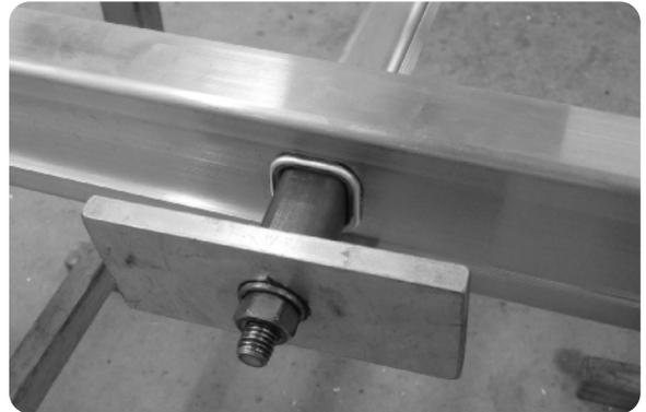
Fixieren Sie das Aufweitgerät mit Schraubzwingen am Leiternholm und drehen Sie die Mutter soweit fest, bis die Sprosse am Inneren des Leiternholms anliegt. Wiederholen Sie den Vorgang auf der anderen Seite.
