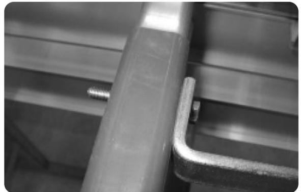
Richten Sie die Seilbremse auf Sprossenmitte aus. Bohren Sie die Bohrungen (Durchmesser 6,5 mm) mit einer Winkelbohrmaschine an der 2. Sprosse ab.
