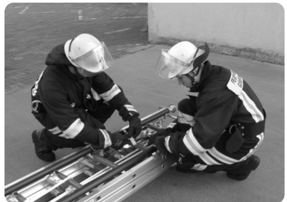
Die Schiebeleiter kann nun von vier Personen von der Einsatzstelle getragen werden. Die Leiter wird mit ausgestrecktem Arm an den Sprossen, mit dem Leiterfuß voraus, getragen.
