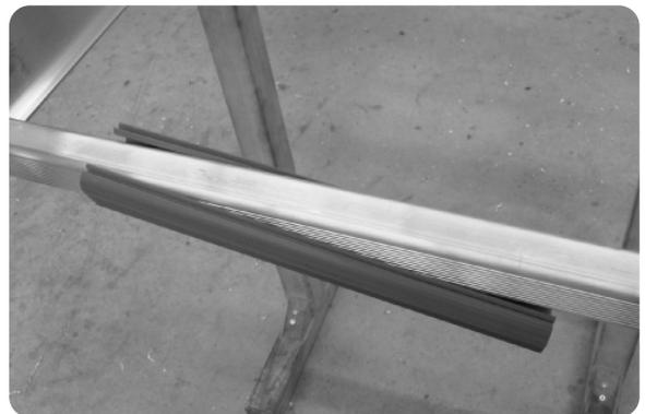
Klemmen Sie den Sprossenbelag mit Hilfe des Montagewerkzeugs an die Sprosse. Achten Sie darauf, dass der Sprossenschutz am Boden der Werkzeugs anliegt und mittig auf der Sprosse sitzt. Der Sprossenschutz lässt sich auch mit zwei stabilen Leisten und Schraubzwingen befestigen.
