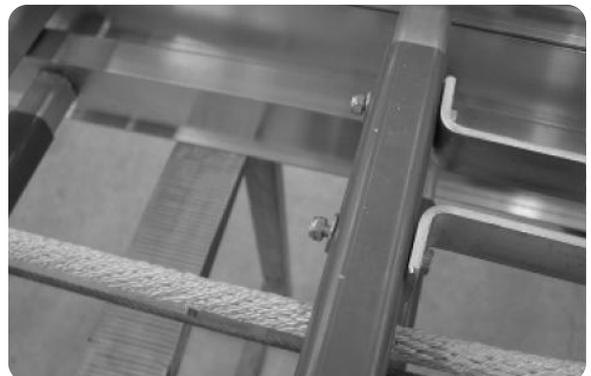
Stellen Sie die Leiter, wie auf Seite 10 beschrieben, auf. Ziehen Sie die Leiter ca. dreieinhalb Sprossen aus. Lassen Sie das Zugseil los, nun muss die Seilbremse die Leiter einbremsen. Um die Seilbremse wieder zu lösen, ziehen Sie diese wieder ein Stück nach oben. Sie können nun die Leiter langsam ablassen. Damit die Seilbremse nicht ungewollt einbremst, muss das Zugseil leicht nach außen, von der Leiter weg, gehalten werden.
