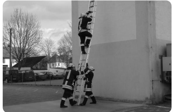
Zum Einfahren der Leiter diese wieder in nahezu senkrechte Stellung bringen; dabei sichern zwei Personen die Leiter an den Holmen oder, wenn vorhanden, an den Stützstangen. Zugseil von der Sprosse lösen und Leiter soweit ausziehen, bis dass die Schlepphaken der Auslösungen über die Sprossen gelangen.
