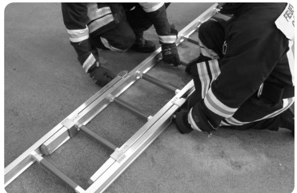
Die beiden oberen Steckleitern werden durch die zwei Trupps zurückgenommen und auf den am Boden liegenden Steckleitern abgelegt.
