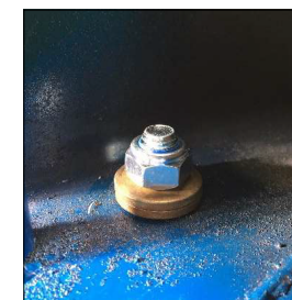
TELLERFEDERN NICHT SO MONTIEREN
