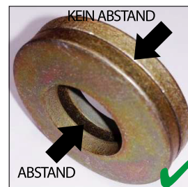
TELLERFEDERN SO MONTIEREN
