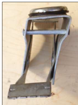
Beschädigung an der Seite und Verformung des Fußpedals aufgrund eines heftigen Seitenaufpralls.
