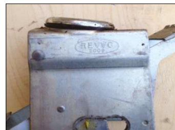
Verformung der oberen Befestigungsplatte aufgrund eines einzigen heftigen Aufpralls oder mehrerer weniger heftiger Aufpralle. Selbst wenn sich die Laufrolle ansonsten in gutem Zustand befindet, muss sie ersetzt werden.
