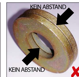
TELLERFEDERN NICHT SO MONTIEREN
