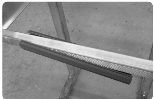
Klemmen Sie den Sprossenbelag mit Hilfe des Montagewerkzeugs an die Sprosse. Achten Sie darauf, dass der Sprossenschutz am Boden des Werkzeugs anliegt und mittig auf der Sprosse sitzt.
