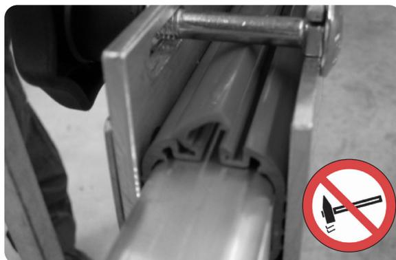
Lösen Sie nun die Schrauben des Montagewerkzeuges und nehmen es ab. Prüfen Sie den Sprossenschutz auf festen Sitz.
