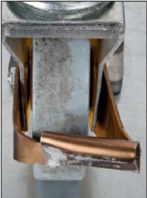
Distorsion du pédalier résultant d'un impact important ; il est probable que la plaque supérieure et le support soient également déformés.
