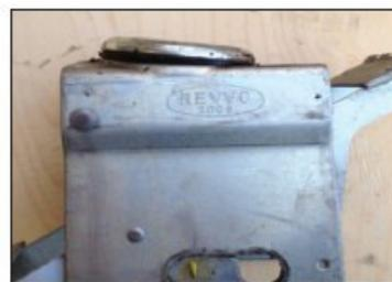
Distorsion de la plaque de montage supérieure résultant d'un seul impact important ou de plusieurs impacts au niveau inférieur. Même si le reste de la roulette est en bon état, elle devra toutefois être remplacée.
