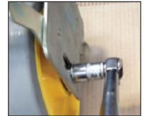
11. Vérifiez que la roulette pivote librement, et abaissez la machine au sol.
