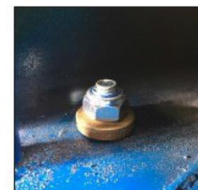
**Boulon de fixation d'une roulette (M12):**
