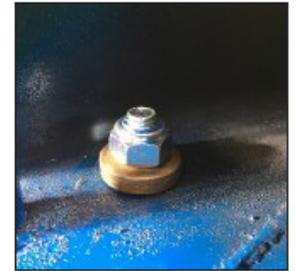
9. Remplacez la roue, l'entretoise d'essieu et le nouvel boulon d'essieu, la rondelle résistante aux vibrations et l'écrou de blocage, en appliquant un verrou par vissage à résistance élevée (Loctite 648) à l'écrou de blocage.
