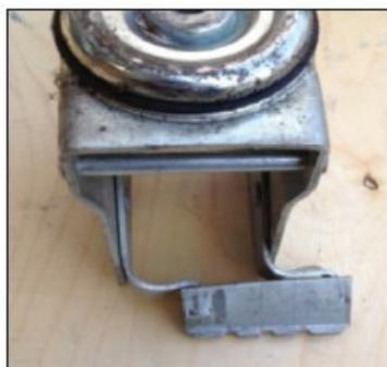
Distorsion du pédalier résultant d'un impact frontal important ; il est probable que la plaque supérieure et le support soient également déformés.
