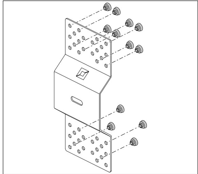
3. Befestigen Sie jeden Sonderhalter mit 12 gewindeformenden Schrauben an der Blechfassade.
